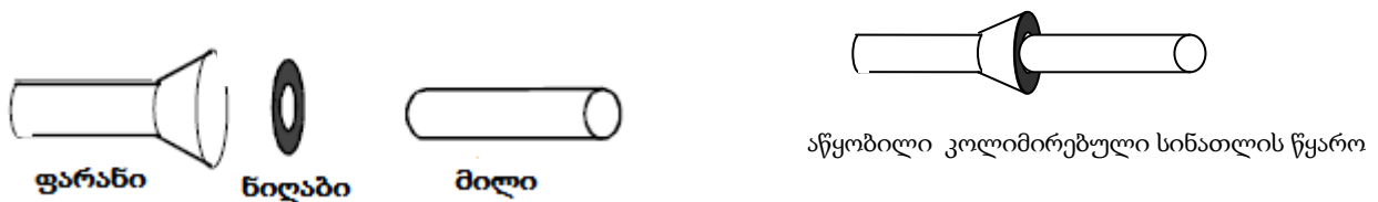
სურათი TG4-1: ფარნისგან წამოსული სინათლისგან პარალელური კონის მისაღები კონსტრუქცია.
