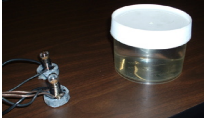
სურათი TG1-8: იაფფასიანი ალტერნატიული ცილინდრული ლინზა: გლუვი კედლების მქონე წყლით სავსე პლასტმასის ქილა.
